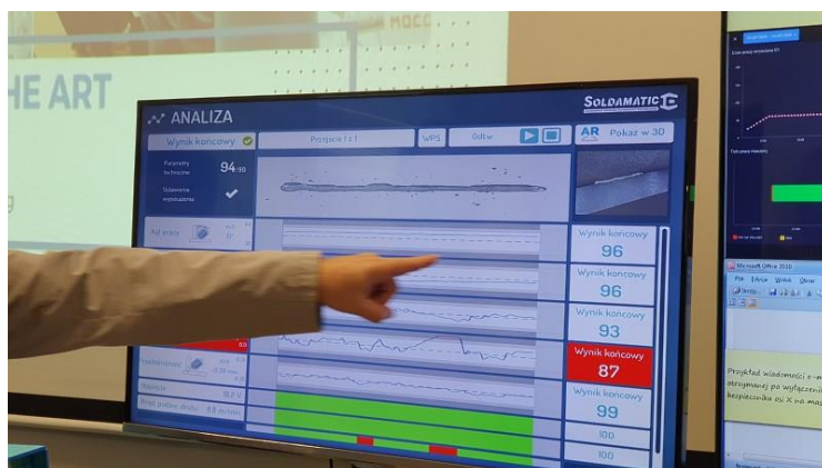
Obraz analizy poprawności przebiegu spawania na monitorze fot. Andrzej Staszczyk
